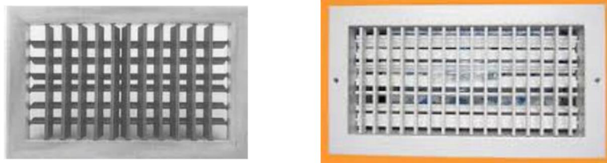
Le **alette orizzontali** **direzionano il getto** d'aria, mentre quelle **verticali** determinano **l'angolo di apertura** e conseguentemente **l'entità della gittata**.
